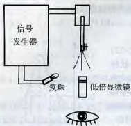
图 2-18 用低倍显微镜目测的 简易型振簧仪示意图
