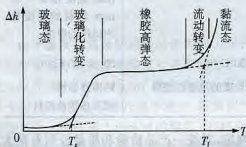
图 5-1 典型的非晶态高聚物的形变-温度曲线
