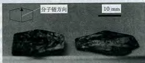
图 6-20 聚双(对甲苯磺酸)-2,4-己二炔-1,6-二醇酯(PTS) 宏观单晶体。极大尺寸已达 26 mm。呈紫黑色和有金属光泽,特别是大分子链不是垂直于晶面而是平躺在晶面内
