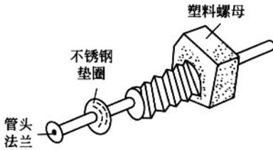
图 3-13 带法兰（凸缘）的低压接头
