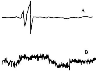
图 5-13 手柄转动 (A) 与检测池气泡 (B) 引起的基线噪声
