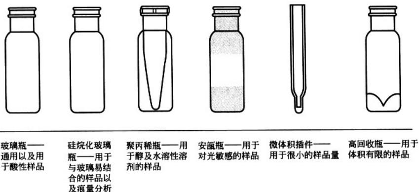
图 11-5 安捷伦公司可以提供的样品瓶的种类
