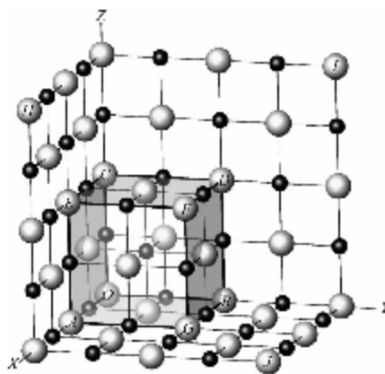
图 1.1 氯化钠部分晶体结构的剖面图
