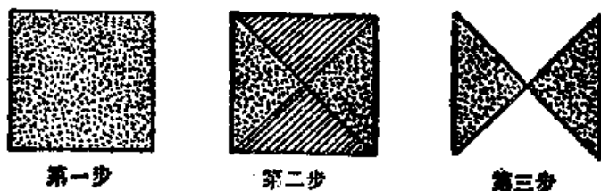
图 2—4 四分法取样步骤图
