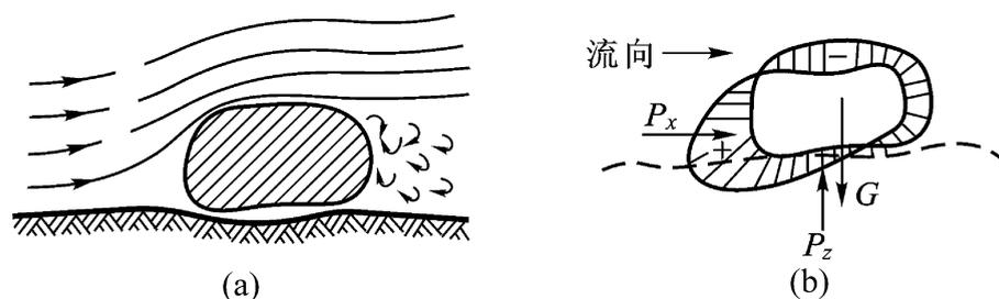
图 3-52 作用于河底沙粒的上举力和推移力
