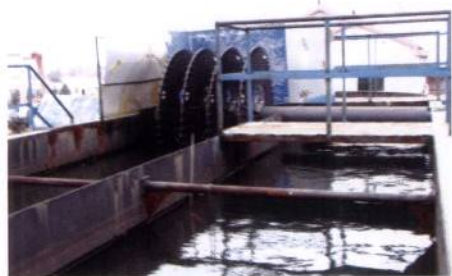
图43-47 Φ1500转碟曝气测试专用试验池
