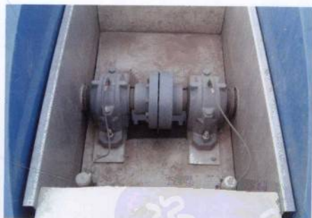
图43-28 多轴连接的转盘曝气机中间连接处（采用机油润滑）
