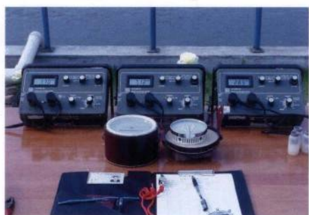
图43-15 标准测试Orbal转盘的仪器设备
