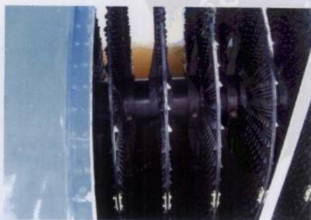
图43-30 静止的 \Phi 1400 转盘及玻璃钢防护罩侧视图
