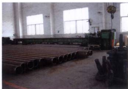
图43-6 切割完成无缝钢管
