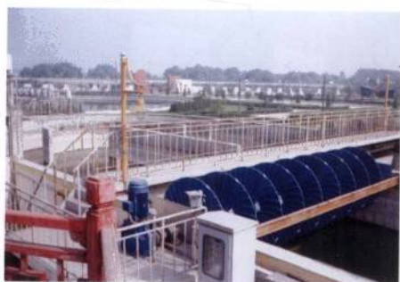
图43-10 临汾污水处理厂 \Phi 1800 和 \Phi 1400 结合的平面状态
