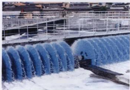
图43-25 \Phi 1800 转盘曝气效果（后端视图）
