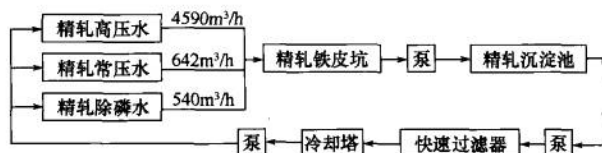
图 39-4 精轧浊循环水系统工艺流程
