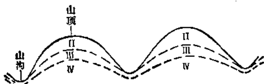
图 22.32 风化壳剖面示意图
